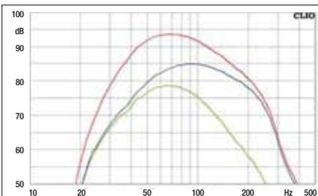
Der Emphaser zeigt erstaunlichen Tiefgang. Die Frequenzweiche arbeitet praxisgerecht und der Boost bei 45 Hz eignet sich zur Beimischung von gemäßigttem Tiefbass
