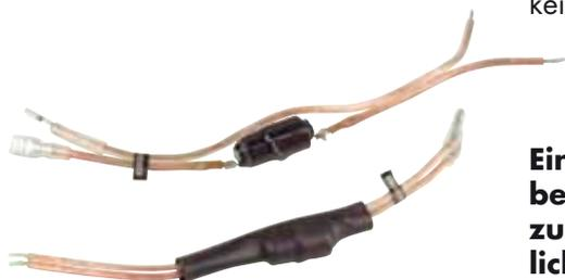
Ein Spülchen bzw. ein Mini-Elko befinden sich in den Zuleitungen zu den Chassis, das ist so ziemlich die Minimallösung
